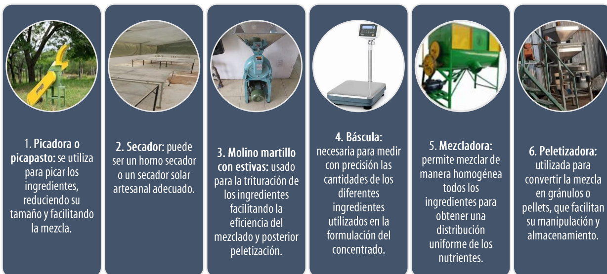
Ilustración 4. Equipos requeridos para el proceso de elaboración de alimentos alternativos tecnificados. Elaboración propia.
